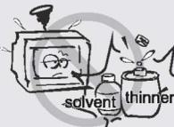
No use detergente para limpiar las superficies del televisor. (Si cae líquido dentro del televisor puede causar una falla, incendio o descarga eléctrica. No use repelente de insectos, solventes, diluyente o solvent diluyente ya que puede deteriorar la superficie y las terminaciones del gabinete.
