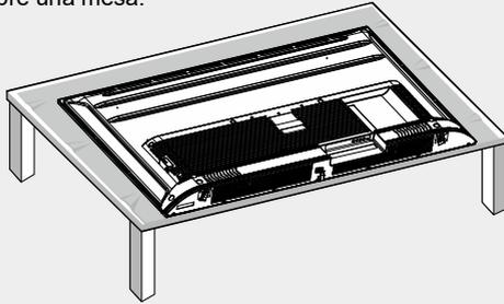
Paso 2: Alinee las bases de los soportes con los orificios correspondientes en la parte inferior del televisor. Inserte y apriete los tornillos para sujetar las patas al televisor.
