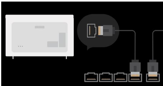
1. Conecte el Puerto del televisor y el router LAN usando un cable LAN. El router debe estar conectado a internet de antemano.
