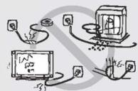
No raye ni empuje el filtro delantero, ni coloque objetos sobre el televisor ya que la imagen se puede distorsionar o dañar la pantalla. Para evitar un incendio, nunca coloque una vela encendida sobre el televisor.
